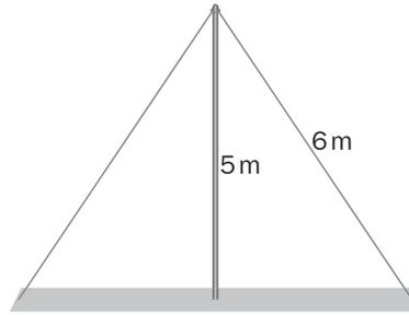
El poste forma un triángulo rectángulo con el suelo, de modo que aplicamos el teorema de Pitágoras:  $6^2 = 5^2 + b^2 \Rightarrow b = 3,32$ . Los cables se han sujetado a 3,32 m de la base del poste.
